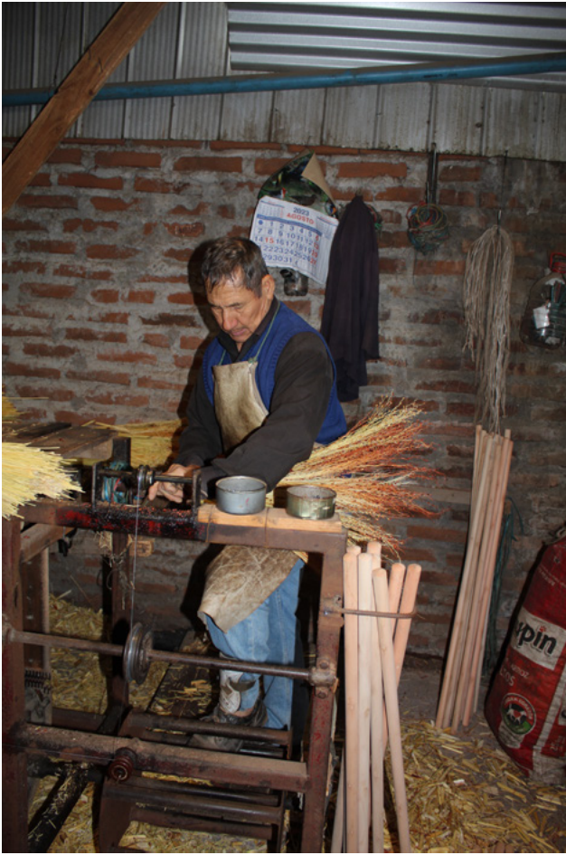
Ensamble de palo y fibras de curahuilla. ©Josefina Tapia
